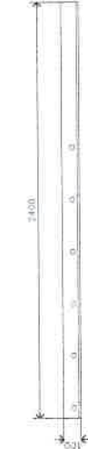
④ เหล็กฉาก ขนาด 100 x 100 x 2400 มม. หน้า 10 มม. จำนวน 2 ชิ้น
