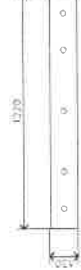
⑤ เหล็กแผ่น ขนาด 130 x 1220 มม. หน้า 12 มม. จำนวน 1 ชิ้น
